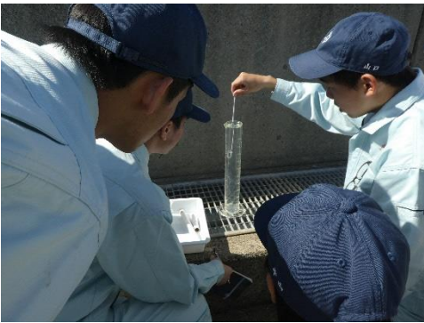
(図4) 赤沼式比重計を用いた塩分濃度測定
